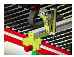
Все электрические гибкие кабели, применяемые на станке, специальные экранированные и выдерживают свыше миллиона циклов на изгиб.
